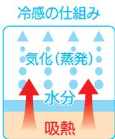
水分が蒸発する際に周囲の熱を奪う「気化熱」を利用。
