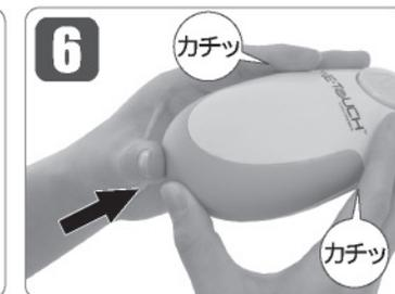
矢印の方向に押し込んで、電池カバーがロックされたことを確認します。
