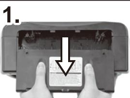
1. 本体底面にある電池カバーをスライドさせます。中に入っている、付属の電池カバー用ネジ(2本)を取り出してください。
