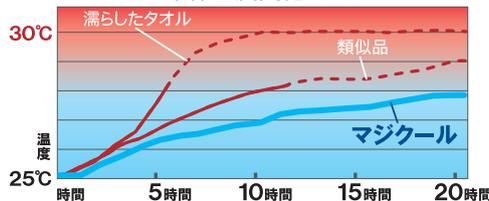
水温約25℃の水道水にときどき揉みながら1.5分浸して吸水させ、余分な水分を脱水した後、恒温恒湿槽内に静置して試料直下の温度変化を熱電対で20時間測定。
