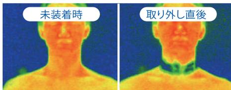
【試験環境】首都圏における夏期の晴天時の気候を想定して30℃-50%に調整した室内で、30分間安静に過ごしたモニターに本体(水で濡らした後同環境下にて30分間放置したもの)を首に装着し、5分後の体表面温度の変化をサーモビューア(熱画像装置)で観察。
