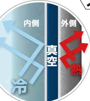
ドリンクボトルには保冷性能（断熱性）に優れたステンレス素材を採用。さらに熱を伝えない真空状態の壁（真空断熱構造）を作ることによって、長時間保冷効果を持続します。ボトルの口が大きいので氷も楽々入れます。水を入れればミストも更にひんやり。
